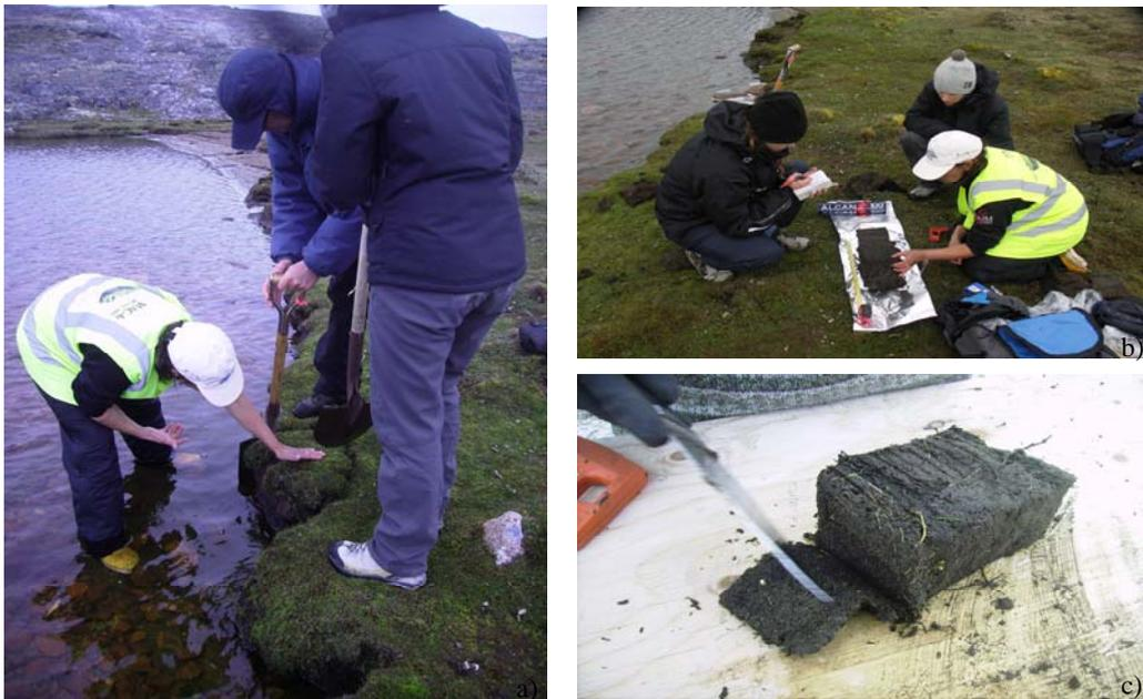
Figure 12 : Echantillonnage (a), description (b) et découpage (c) du monolithe de l'île Nuvuk NK3
