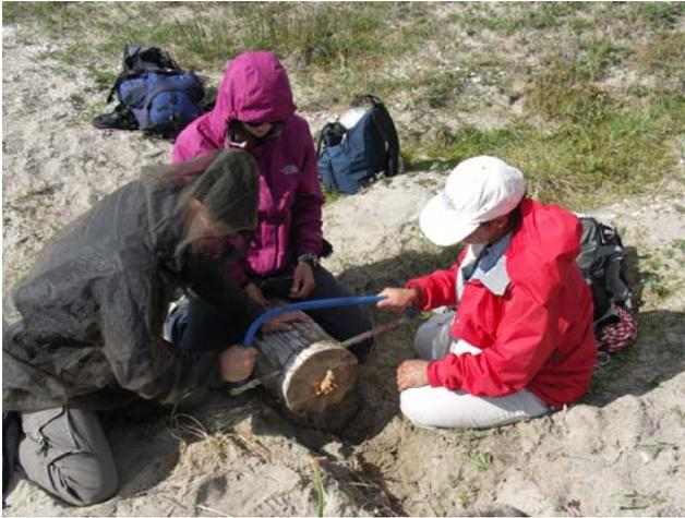
Figure 22 : Echantillonnage d'une galette de bois à la scie sur une plage aux environs du village d'Inukjuak
